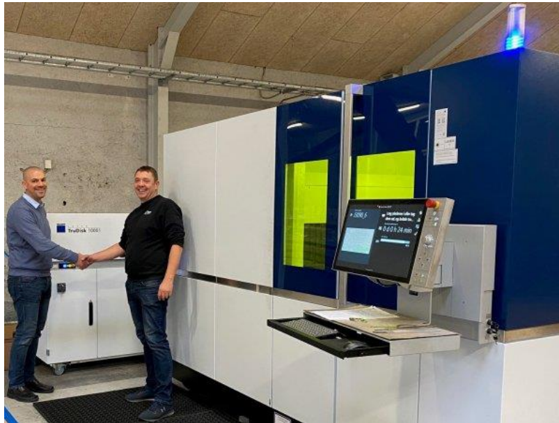
Den tredje TRUMPF-laserskæremaskine hos MITECH er en TruLaser 5030 med ti kiloWatt fiberresonator. AVN Pladetekniks Morten Dahl (t.v.) og den ene af de to MITECH-indehavere Morten Bertelsen (t.h.) ses her ved den igangsatte leverance.
