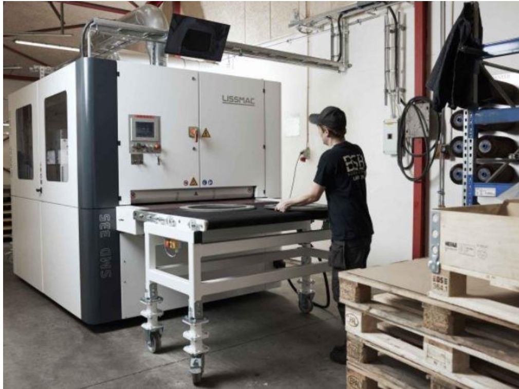
BSB Industry har installeret denne LISSMAC SMD 335REE-maskine i slibeværkstedet i Lunderskov, hvor maskinoperatør Nicki Hjort Andersen her er i færd med efterbearbejdningen af flanger til kompensatorer.
