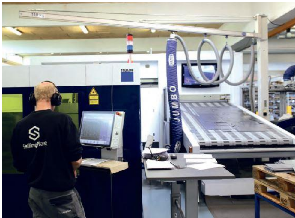
De laserskårne, udplukkede emner kommer kørende 'til døren' efter PartMaster opgraderingen.
