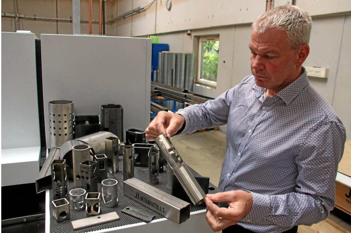
JB Metalindustri har investeret i en rørlaserskærer fra TRUMPF. Maskinen kan på få øjeblikke bearbejde profiler og rør, som ellers skulle være skåret og fræset i hånden. Foto: Simon Dinsen Hansen
