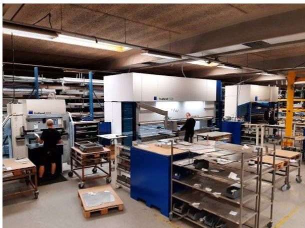
Maskinparken ved firmaet Claus Andersen Rustfri Stål er aktuelt tilføjet en 4 meter TruBend 5320-kantpresse, og tæller herefter i alt tre kantpresser.
